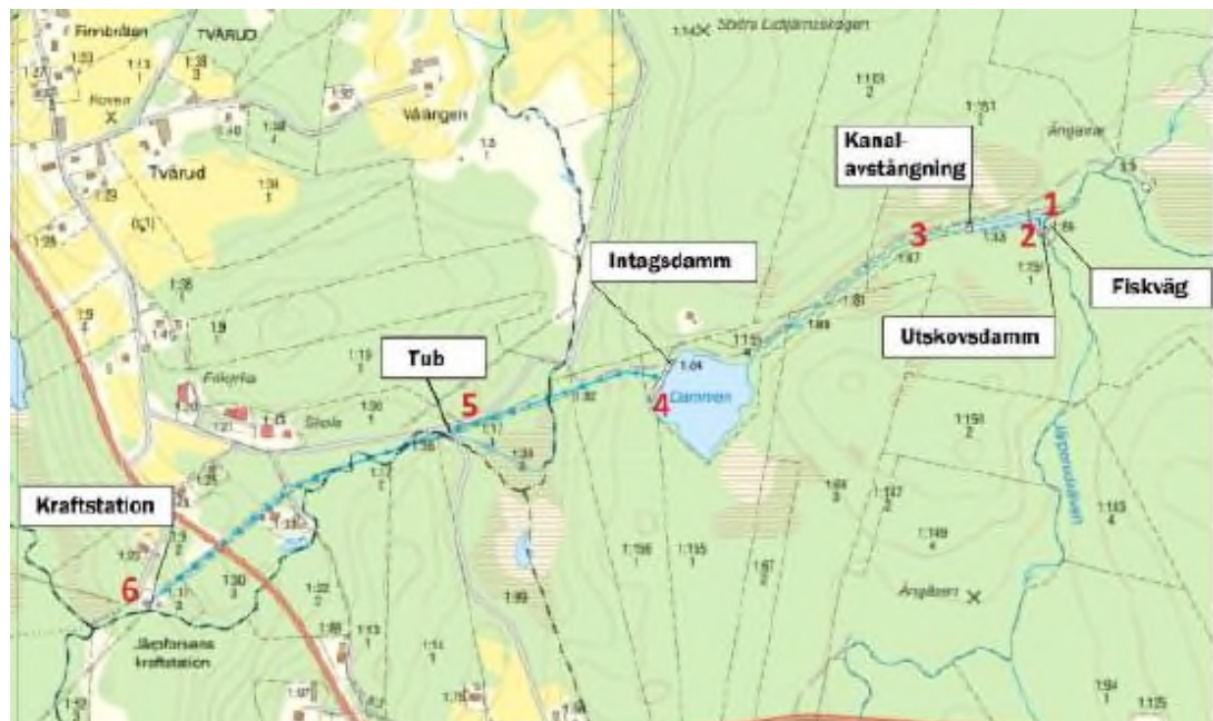
Figur 1. Karta över anläggningsdelar tillhörande Järpforsens kraftverk
